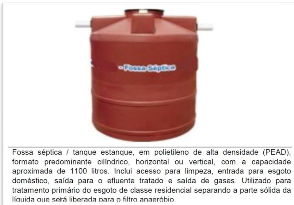
Fossa séptica / tanque estanque, em polietileno de alta densidade (PEAD), formato predominante cilíndrico, horizontal ou vertical, com a capacidade aproximada de 1100 litros. Inclui acesso para limpeza, entrada para esgoto doméstico, saída para o efluente tratado e saída de gases. Utilizado para tratamento primário do esgoto de classe residencial separando a parte sólida da líquida que será liberada para o filtro anaeróbio.
