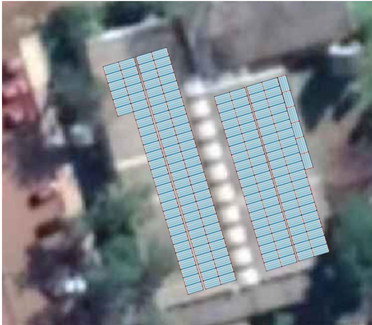
Figura 3 – Alocação dos painéis
