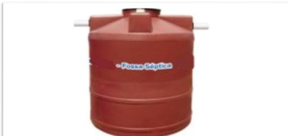
Fossa séptica / tanque estanque, em polietileno de alta densidade (PEAD), formato predominante cilíndrico, horizontal ou vertical, com a capacidade aproximada de 1100 litros. Inclui acesso para limpeza, entrada para esgoto doméstico, saída para o efluente tratado e saída de gases. Utilizado para tratamento primário do esgoto de classe residencial separando a parte sólida da líquida que será liberada para o filtro anaeróbio.
