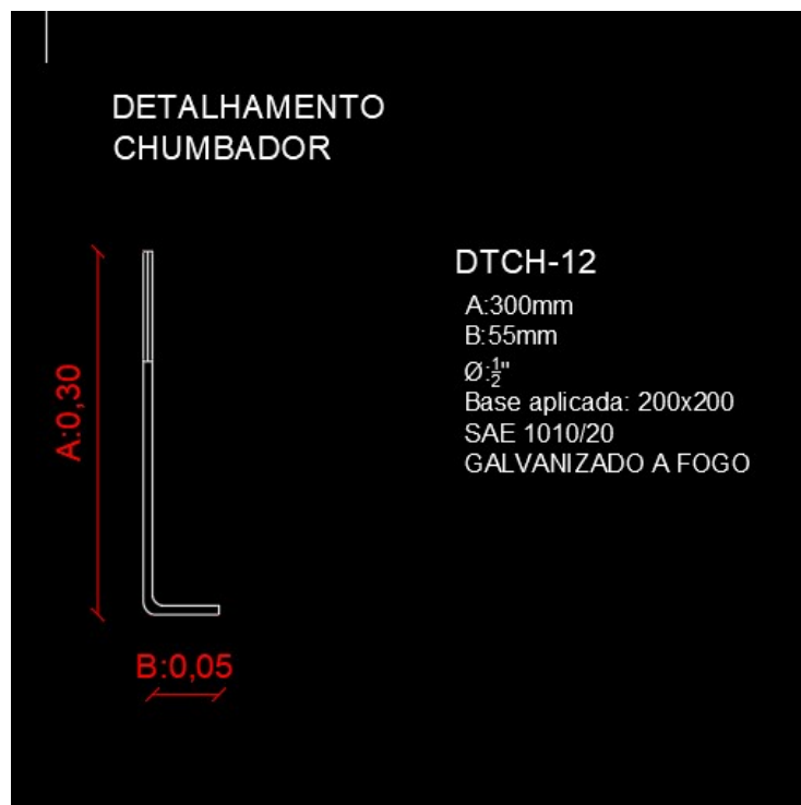
Imagem 03: Detalhamento chumbador
