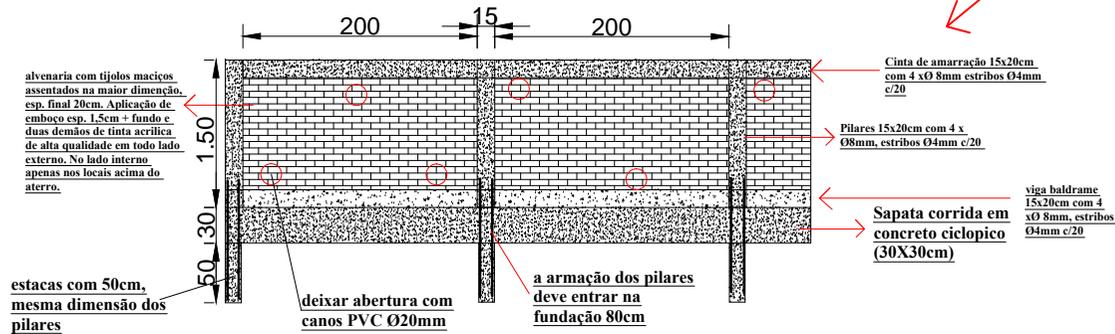
Muro a ser executado com tijolos maciços esp. 20cm, emboço 1,5cm de esp. + pintura em duas demãos
