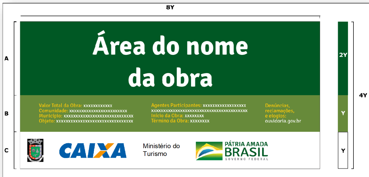
Figura 01: Modelo de Placa de Obra
