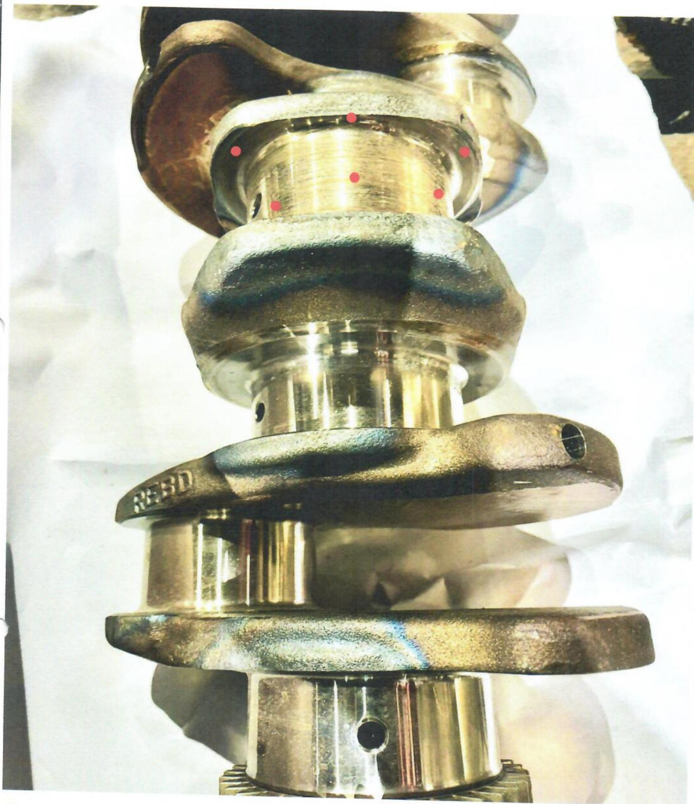
Quando o eixo virabrequim fica sem lubrificação, as peças móveis do motor entram em atrito direto, causando desgaste e aquecimento excessivo. Isso pode levar a danos graves ao virabrequim, como. Desgaste dos colos do virabrequim. Empenamento do virabrequim. Quebra do virabrequim. Ilustração do colo de biela, munhão do quinto cilindro.
