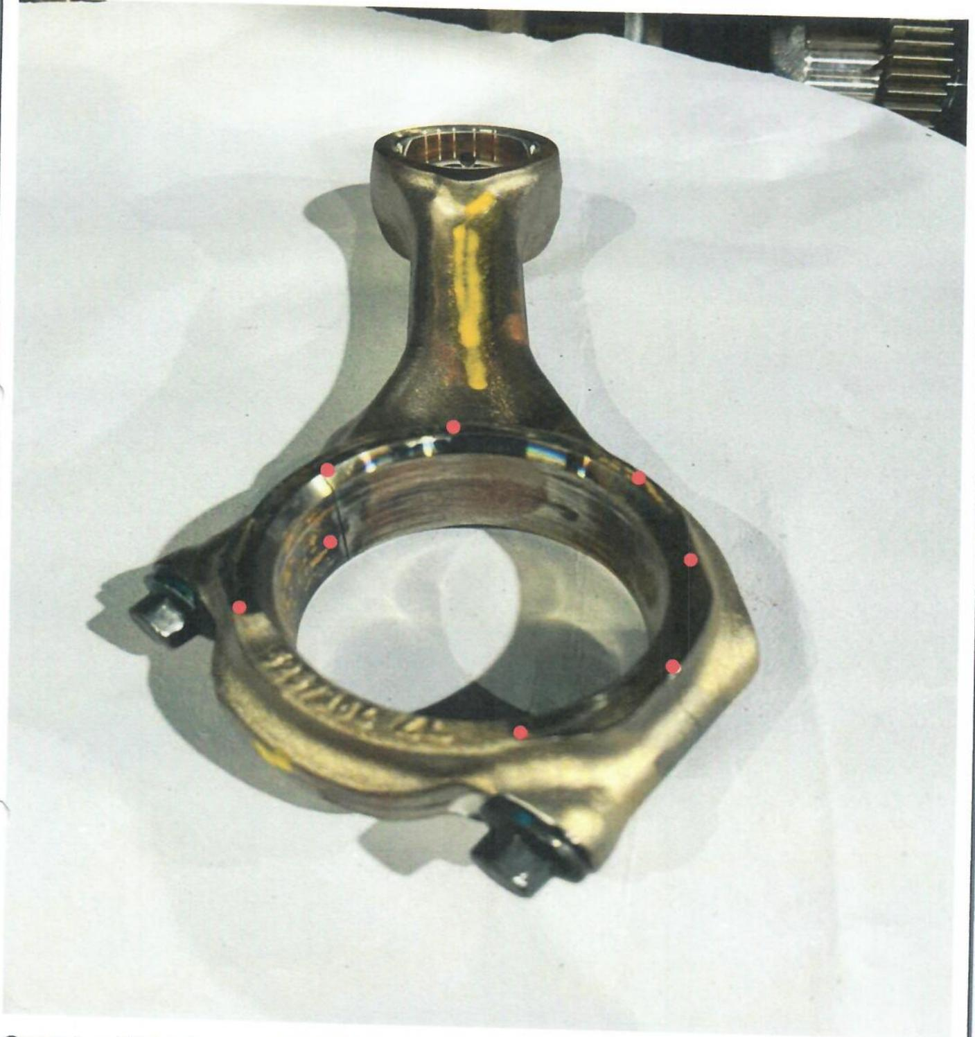
Quando a biela de um motor não recebe lubrificação adequada, ocorre um aumento do atrito entre as peças móveis, o que pode levar a danos graves, como o travamento da biela. Os sintomas mais comuns de falta de lubrificação na biela incluem: Ruídos metálicos provenientes do motor. Aumento da temperatura do motor. Perda de potência e Luz de advertência do motor acesa.
