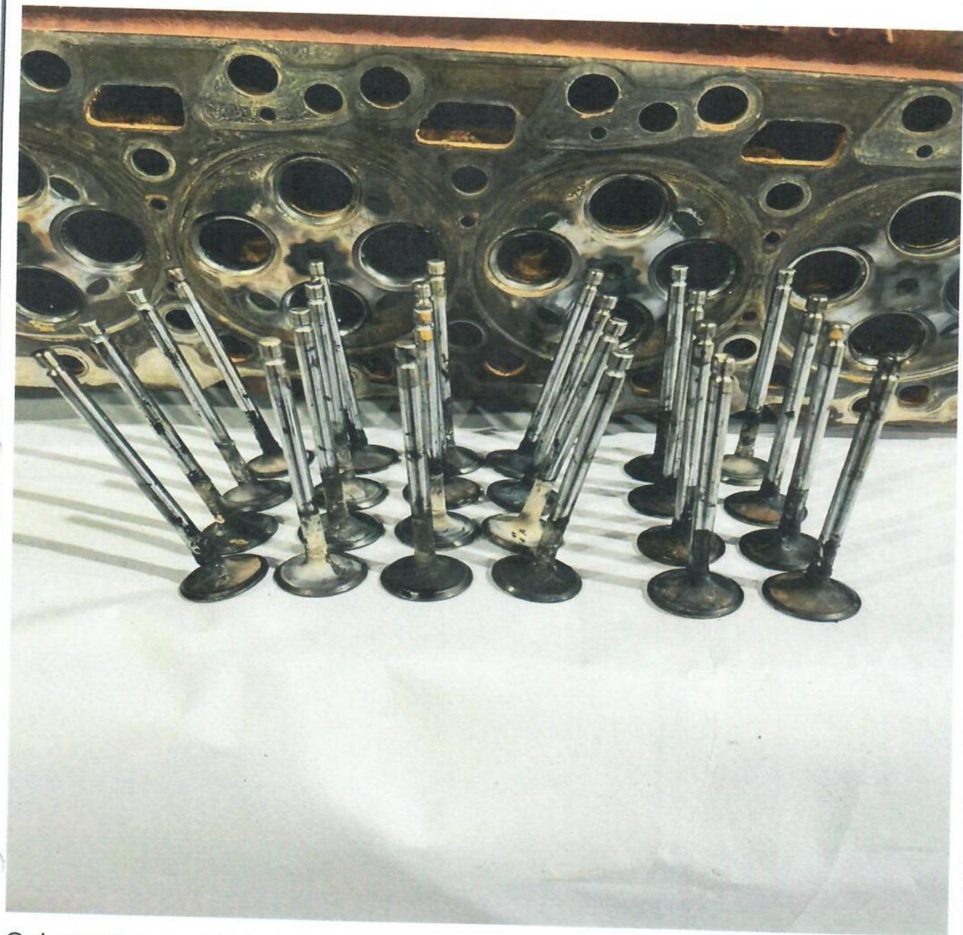
O desgaste nas válvulas pode ser causado por uma série de fatores, incluindo. Temperatura elevada, as válvulas são expostas a temperaturas elevadas durante o funcionamento do motor, o que pode causar a deformação ou o desgaste do material. Óleo de motor é responsável por lubrificar as válvulas, mas se estiver contaminado com sujeira ou outros contaminantes, pode acelerar o desgaste das válvulas. Combustível de má qualidade pode conter impurezas que podem causar o desgaste das válvulas.
