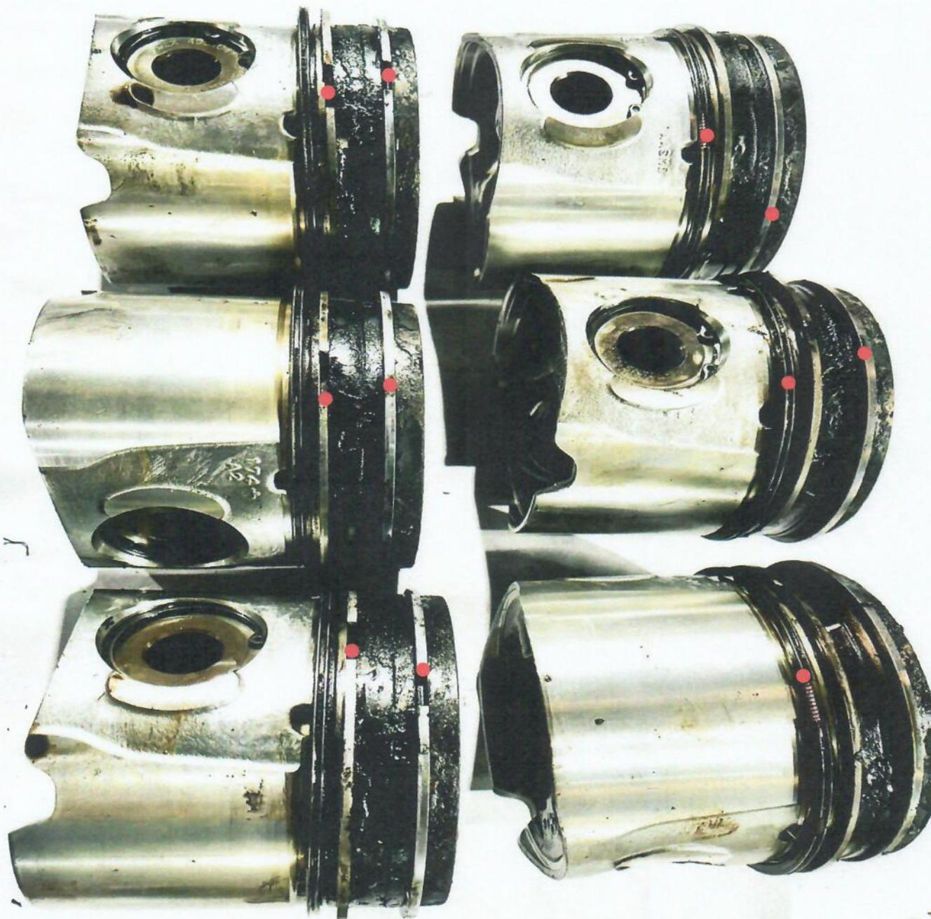
Os pistões apresentaram, desgaste elevado na canaleta, região de vedação dos pistões. A finalidade dos anéis de pistões e manter a lubrificação dos cilindros, retirar o excesso de óleo que contem na parede do cilindro e ter vedação da compressão ocasionado pela combustão interna dentro do cilindro.
